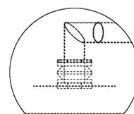
Изображение: донный клапан, донный клапан, противовихревая пластина. Для обеспечения полезной производительности в соответствии разделом 12 стандарта UNI EN 12845.
