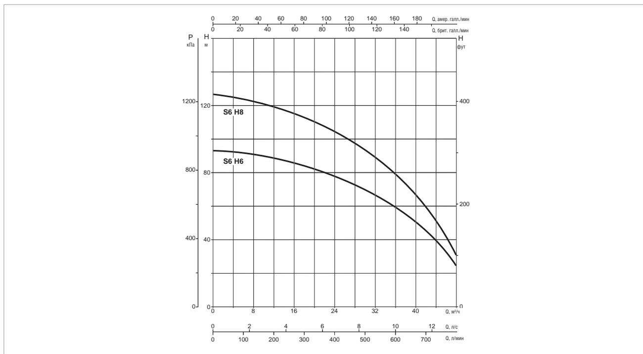
Кривые производительности основаны на значениях кинематической вязкости, равной 1 мм²/с, и плотности, равной 1000 кг/м³. Погрешность кривых соответствует ISO 9906.
