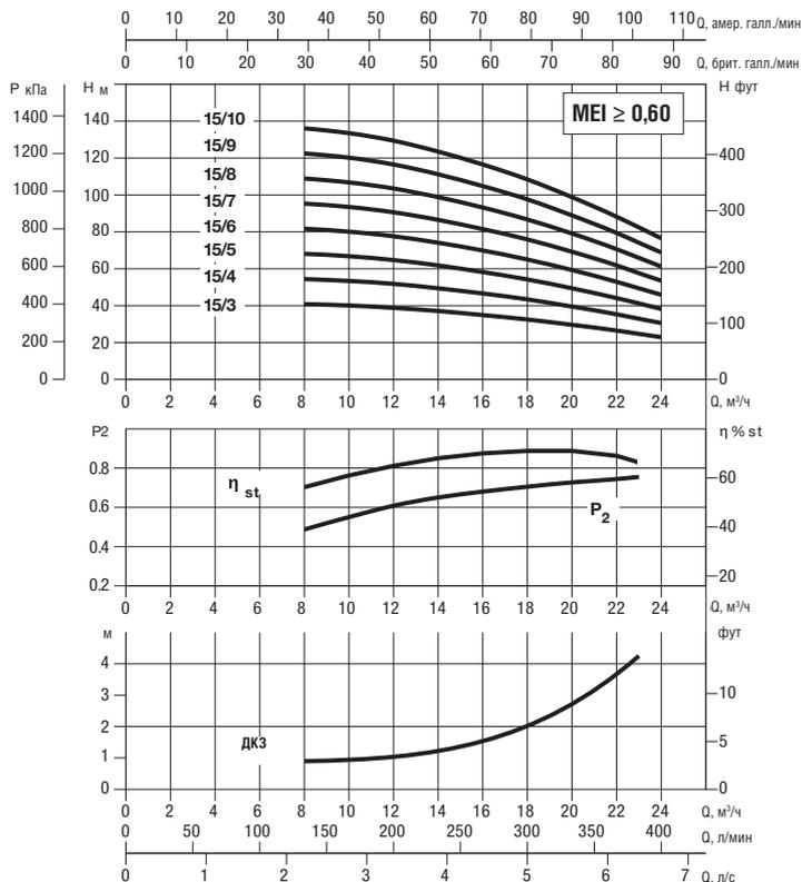
Кривые производительности и электрические характеристики относятся к работе одного насоса.
