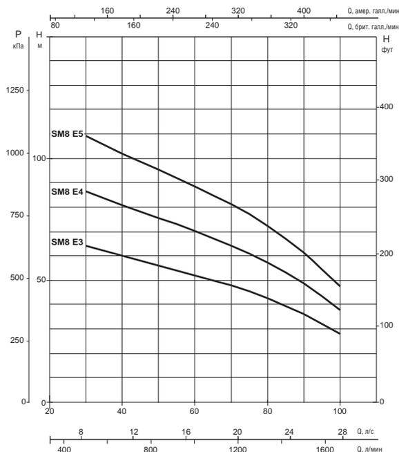
Кривые производительности основаны на значениях кинематической вязкости, равной 1 мм²/с, и плотности, равной 1000 кг/м³. Погрешность кривых соответствует ISO 9906.
