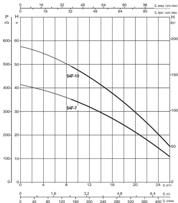
Кривые производительности основаны на значениях кинематической вязкости, равной 1 мм²/с, и плотности, равной 1000 кг/м³. Погрешность кривых соответствует ISO 9906.
