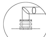
Изображение: донный клапан, донный клапан, противовихревая пластина. Для обеспечения полезной производительности в соответствии раздела 12 стандарта UNI EN 12845.
