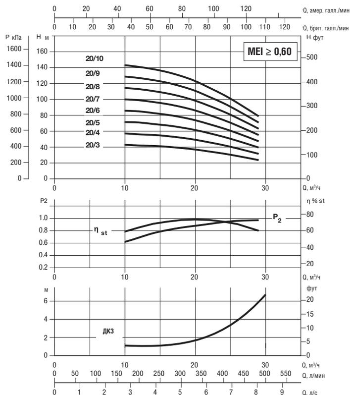
Кривые производительности и электрические характеристики относятся к работе одного насоса. Кривые производительности основаны на значениях кинематической вязкости, равной 1 мм²/с, и плотности, равной 1000 кг/м³. Погрешность кривых соответствует ISO 9906.
